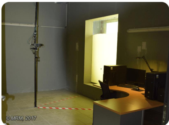
Ci-dessus : La caméra et la fenêtre d'observation des espèces traversant la passe du barrage de Sauveterre.
