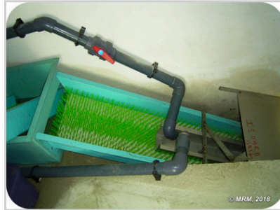
Ci-dessus : De gauche à droite, le bac de piégeage des civelles, la rampe de reptation en brosses, et la libération des individus après biométrie ((C) MRM)
